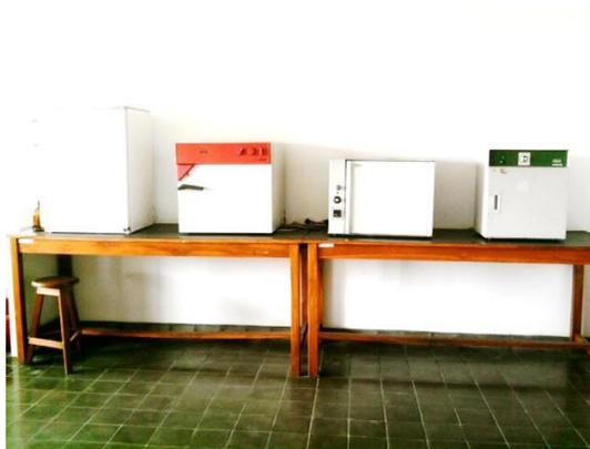
Gambar 2. 18: Macam –macam Oven untuk sterilisasi kering
