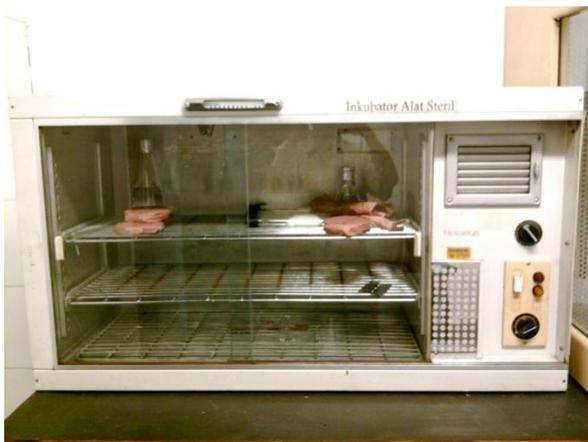
Gambar 2.10 : Ruang Inkubasi Steril yang telah ditanami eksplan
