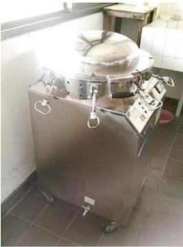
Gambar 2.20: Autoclave untuk
